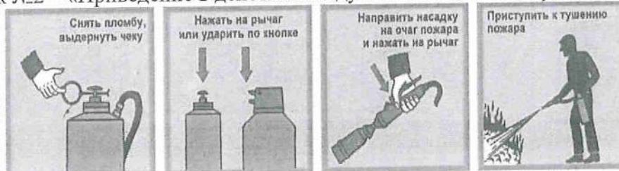
Рисунок №2 – «Приведение в действие воздушно-пенного огнетушителя»
